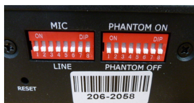
FIGURE 2 – Dip switches sur la face arrière de NUT
