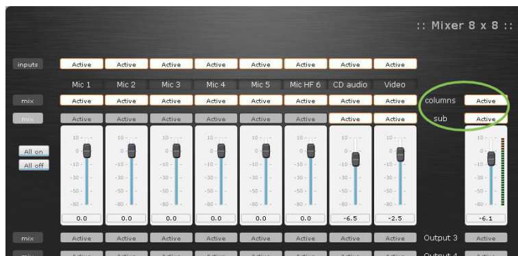
FIGURE 20 – Configuration du mixer pour la gestion d'un caisson de graves
