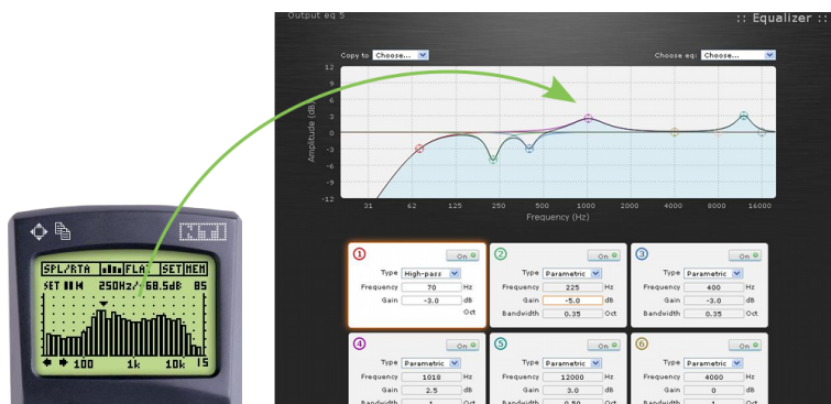
FIGURE 10 – Egalisation de la diffusion dans les égaliseurs de sortie
