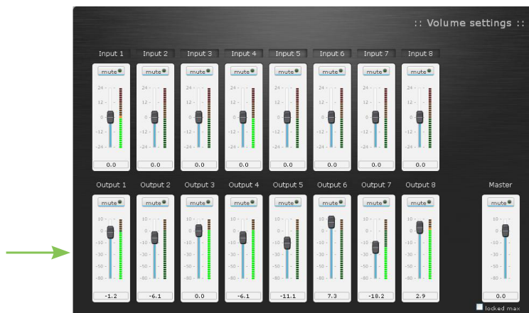
FIGURE 9 – Réglage de la couverture sonore avec les gains de sortie dans le bloc-fonction Volume
