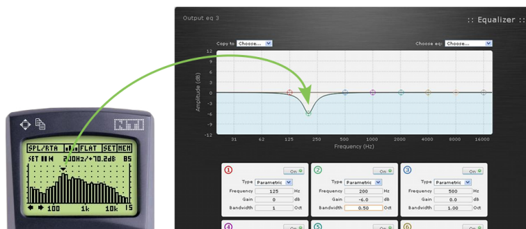
FIGURE 11 – Egaliser le retour enceintes -> micro dans les égaliseurs de sortie
